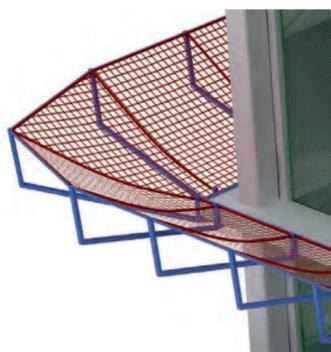
Red de seguridad sujeta a consolas para utilización horizontal
