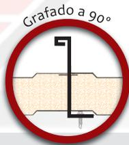
Láminas en acero galvanizado arriba y abajo calibre 28, 26 o 24 con o sin pintura poliéster al horno
