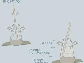
4. Enrase, retire los sobrantes y levante verticalmente el molde durante  $5 \text{ s} \pm 2 \text{ s}$  sin tocarlo, girarlo 2. Al compactar las capas o moverlo lateralmente. segunda y tercera la varilla
