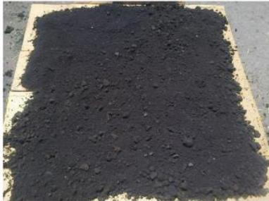
Asfalto Natural de Bajo contenido de Bitumen
