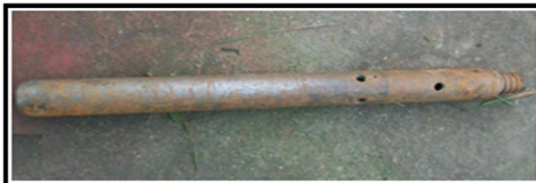
CONO DE PENETRACIÓN STANDAR (SPT).
