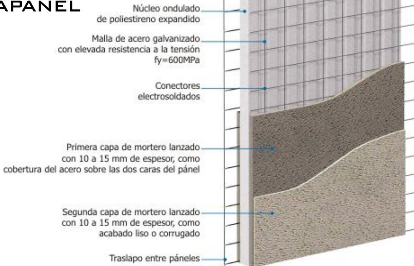
Durapanel es un sistema constructivo, sismo-resistente, termo-acústico, monolítico y homogéneo, compuesto por paneles de poliestireno expandido, integrado con dos mallas de acero galvanizado adheridas a la lamina por medio de conectores en acero, permitiendo la transferencia de esfuerzos en ambas caras del panel lo cual origina altas prioridades estructurales.
