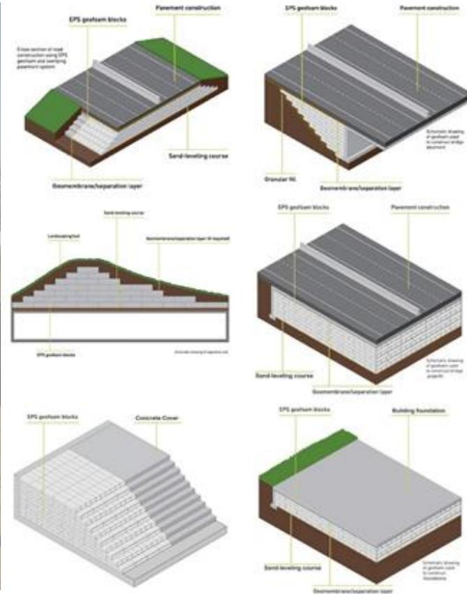
El Durafoam es un sistema ultraliviano para llenos en geotecnia de alrededor del 1% del peso de los materiales tradicionales. Compuesto por Geobloques manoportables de poliestireno expandido (EPS) producidos industrialmente, permite lograr reducciones sustanciales en cargas, costos y tiempos.
