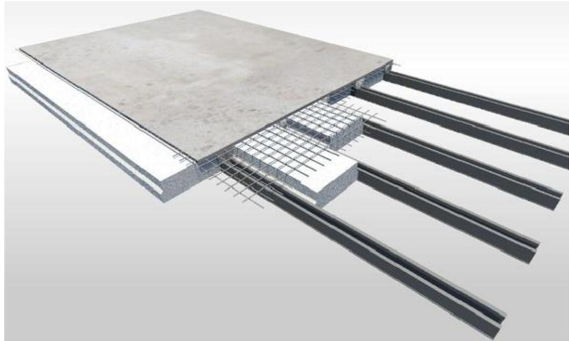
La Duralosa es un sistema de losas para entrepisos y/o cubiertas conformado por bovedillas en poliestireno expandido (EPS) de clase auto-extingible y viguetas prefabricadas en concreto o perfiles metálicos, los cuales en conjunto con el vaciado de concreto y la malla electro-soldada, según el diseño estructural, generan un sistema de losa de entrepiso nervada unidireccional.
